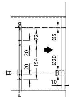
Profundidade de instalação ≥ 310mm
