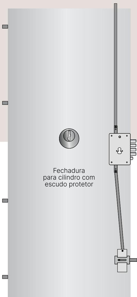
Fechadura para cilindro com escudo protetor
