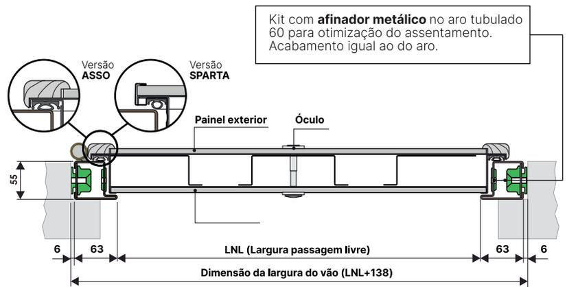
Nota: o aro tubulado deve ser assente à face da parede interna acabada e sobre o chão final (cota zero).
