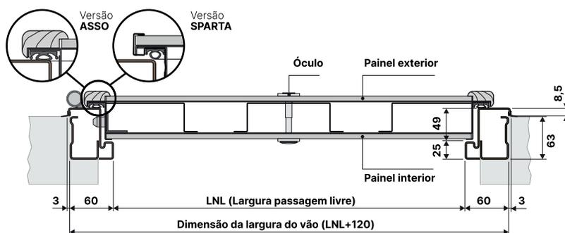
Nota: o aro deve ser assente à face da parede interna acabada e sobre o chão final (cota zero).
